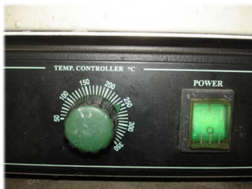
ภาพที่ 5 แสดงการปรับตั้งอุณหภูมิ hot plate
