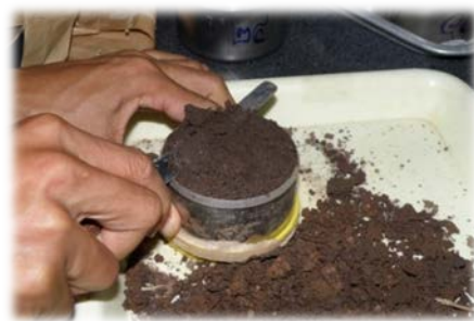
ภาพที่ 17 ภาพแสดงการเตรียมตัวอย่างดิน core ในห้องปฏิบัติการ เพื่อวิเคราะห์ความหนาแน่นรวม
