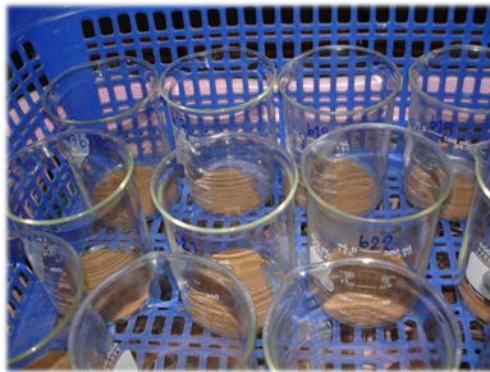
ภาพที่ 1 ตัวอย่างดินที่ผ่านตะแกรงร่อนขนาด 2 mm จำนวน 10.0 g ในบีกเกอร์ขนาด 600 mL
