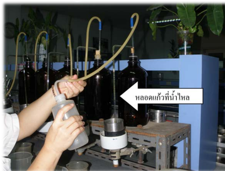
ภาพที่ 26 การอัดอากาศไล่น้ำในขวดแก้วให้ไหลผ่านแท่งแก้วรูปตัวยูลงบน Core เก็บตัวอย่างดิน
