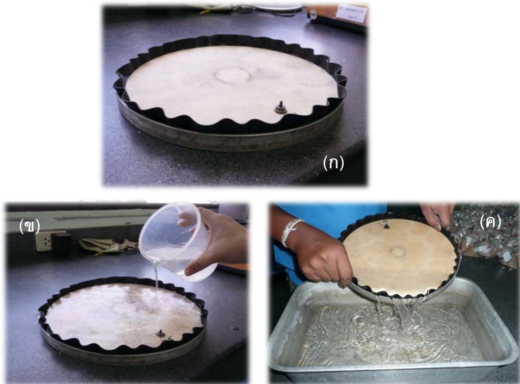
ภาพที่ 29 การเตรียม pressure plate ที่สวมลงในวงเหล็ก (ก) เชน้ำกรอง (ข) และ plate ที่อิมตัวด้วยน้ำ (ค) สำหรับวิเคราะห์ปริมาณความชื้นของดิน ที่แรงดันบรรยากาศ 1/3 และ 15 bar
