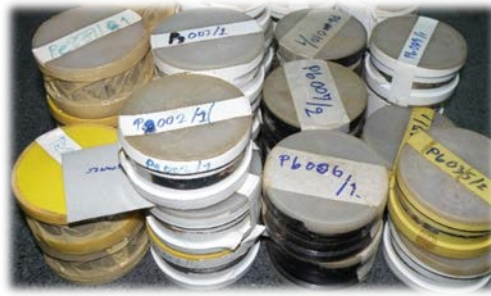
ภาพที่ 16 ภาพแสดงตัวอย่างที่เก็บด้วย core แบบไม่รบกวนโครงสร้าง
