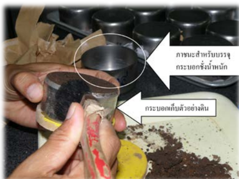
ภาพที่ 18 ภาพแสดงการทำความสะอาดและการชั่งน้ำหนักตัวอย่างดิน core เพื่อหาปริมาณความชื้นดิน ( W_{sw} )
