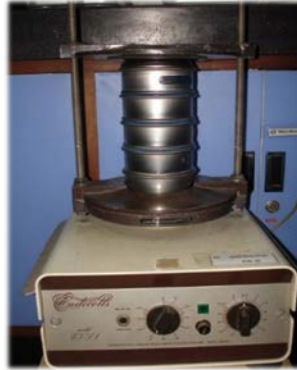
ภาพที่ 12 แสดงการนำชุดตะแกรงร่อนเข้าเครื่องเขย่า
