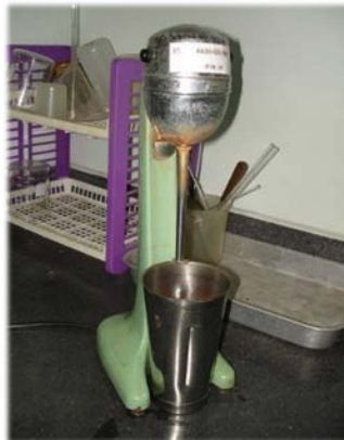
ภาพที่ 9 แสดงตัวอย่างดินที่ปั่นด้วย high speed stirrer
