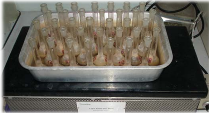
ภาพที่ 21 การต้มไล่ฟองอากาศออกจากตัวอย่างดินใน volumetric flask ขนาด 50 mL ด้วย water bath
