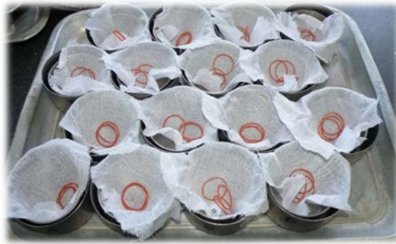
ภาพที่ 28 อุปกรณ์ที่ใช้ในการวิเคราะห์การนำน้ำของดินซึ่งทำความสะอาดแล้ว และเตรียมชั่งน้ำหนักรวม
