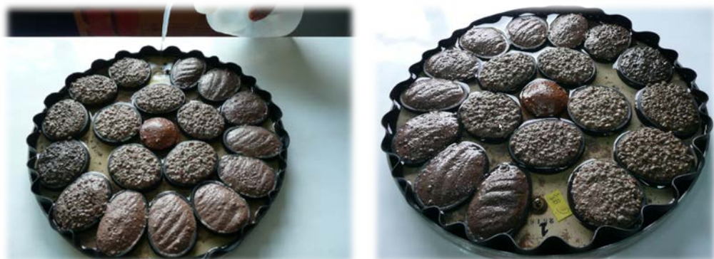
ภาพที่ 31 การเติมน้ำลงบนที่ว่างนอกวงแหวนยางของ pressure plate ด้วยกระบอกฉีดยา
