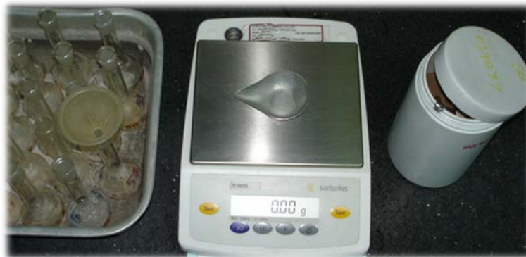
ภาพที่ 20 การชั่งน้ำหนักตัวอย่างดินใส่ใน volumetric flask ขนาด 50 mL
