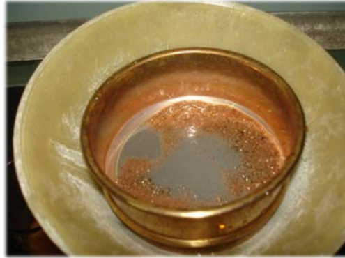
ภาพที่ 10 แสดงการถ่ายตัวอย่างดินผ่านตะแกรงขนาด 300 mesh
